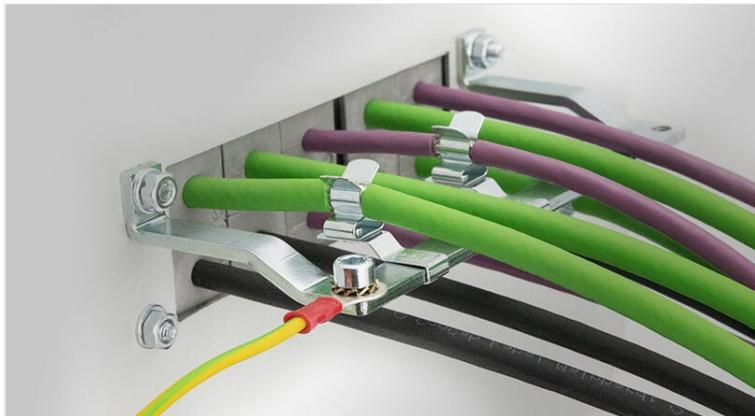
La escuadra KEL-EMC-PF en combinación con los [clips de pantalla de cables PFS|SKL](#) forman un conjunto que permite conducir y derivar a tierra las perturbaciones retenidas por las pantallas de los [cables del pasacables / pasamuros partidos](#).
